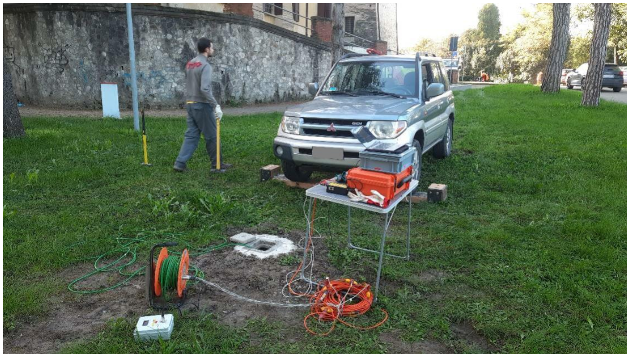
FIG. 3 – REALIZZAZIONE DELLA PROVA SISMICA DOWN-HOLE IN COMUNE DI SAN POLO D'ENZA
